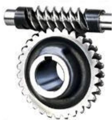
Abbildung 2: Schneckengetriebe [Mfgc14]
