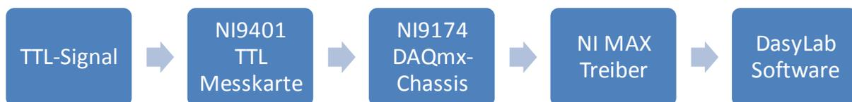
**Abbildung 20: Drehzahlsignalerfassung über Messkarte NI 9401**
