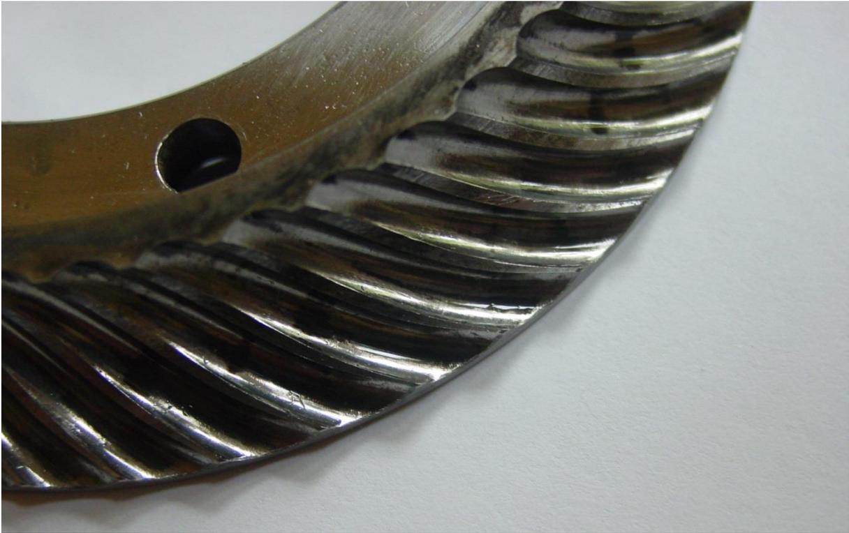
**Abbildung 45: Großes Kugelschneckengetriebe-Rad [Boga14]**
