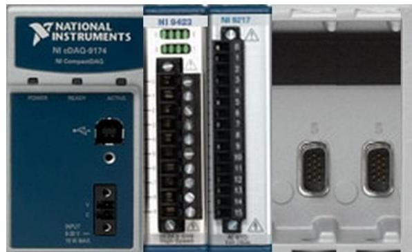
Abbildung 24: Messmodul für die Signalerfassung von National Instruments. Beinhaltet digitale Messkarte und Temperaturmesskarte [Nico13]
